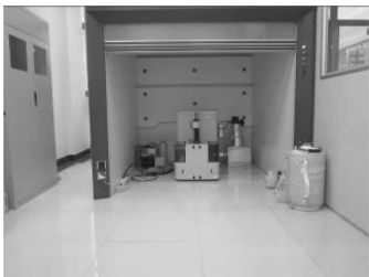
图 1 Poremaster33 高压孔隙结构仪
