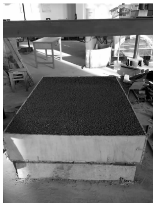
图 1 透水混凝土模型路段
