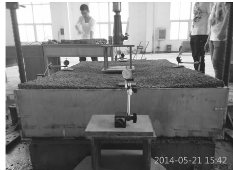
图 6 透水混凝土模型加载破坏形态
